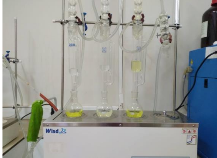
Şekil 2. 1. Tohum yağlarından yağ eldesi için Soxhlet ekstraksiyon düzeneği
